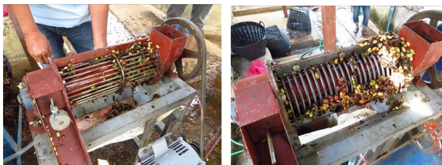
ภาพที่ 4.8 ลักษณะเสื่อตะแกรงแบบแนวนอน (ซ้าย) และแบบแนวตั้ง (ขวา)
