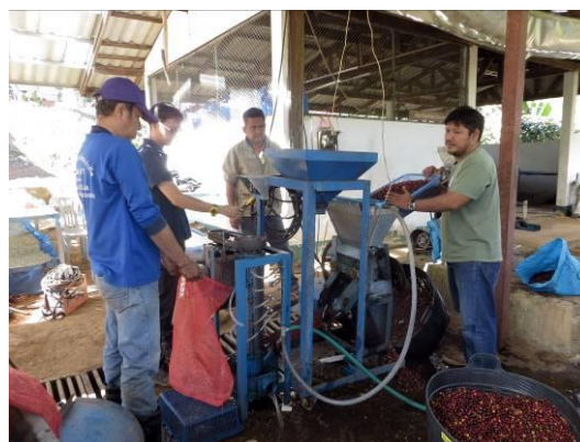
ภาพที่ 4.15 การทดสอบต้นแบบเครื่องขัดล้างเมือกกาแฟเบื้องต้นที่ศูนย์วิจัยเกษตรหลวงเชียงใหม่ (ขุนวาง)
