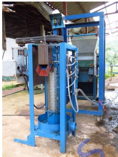
ภาพที่ 4.13 ต้นแบบเครื่องขัดล้างเมื่อกาแฟ
