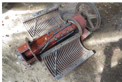
ภาพที่ 4.9 แกนรีดผลกาแฟแบบมีฟันและมีเกลียวก้นท้าย
