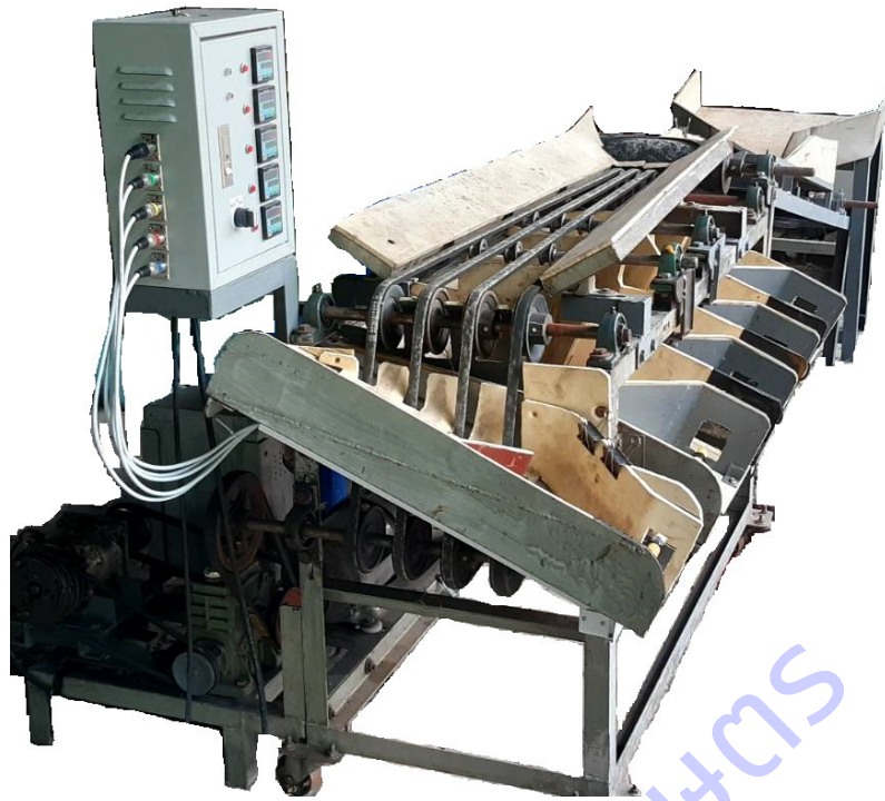
ภาพที่ 5 ต้นแบบเครื่องคัดขนาดหัวมันฝรั่งแบบสายพานหลังปรับปรุง
