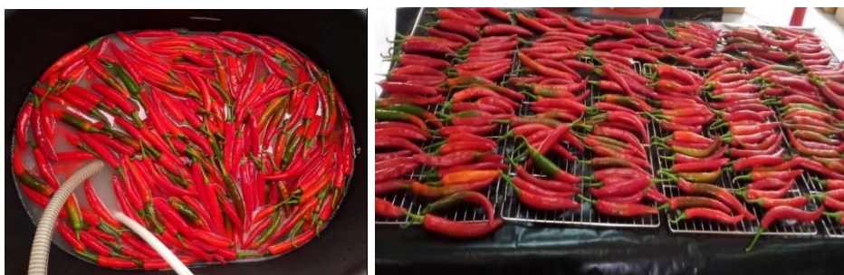
ภาพภาคผนวกที่ ข7 การดำเนินงานทดลองการใช้เทคโนโลยีฟองอากาศขนาดไมโครและนาโนร่วมกับโซเดียมไฮคาร์บอเนตในการล้างทำความสะอาดพริกชี้ฟ้า ปี 64
