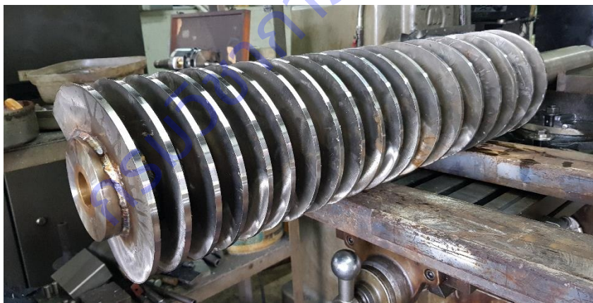
ภาพที่ 15 เชื่อมใบสกรูกับแกนเพื่อเป็นสกรูอัดแบบ Variable pitch screw
