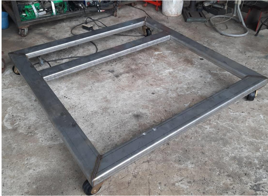
ภาพที่ 12 ฐานรองต้นแบบส่วนสกัดด้วยตัวทำละลาย
