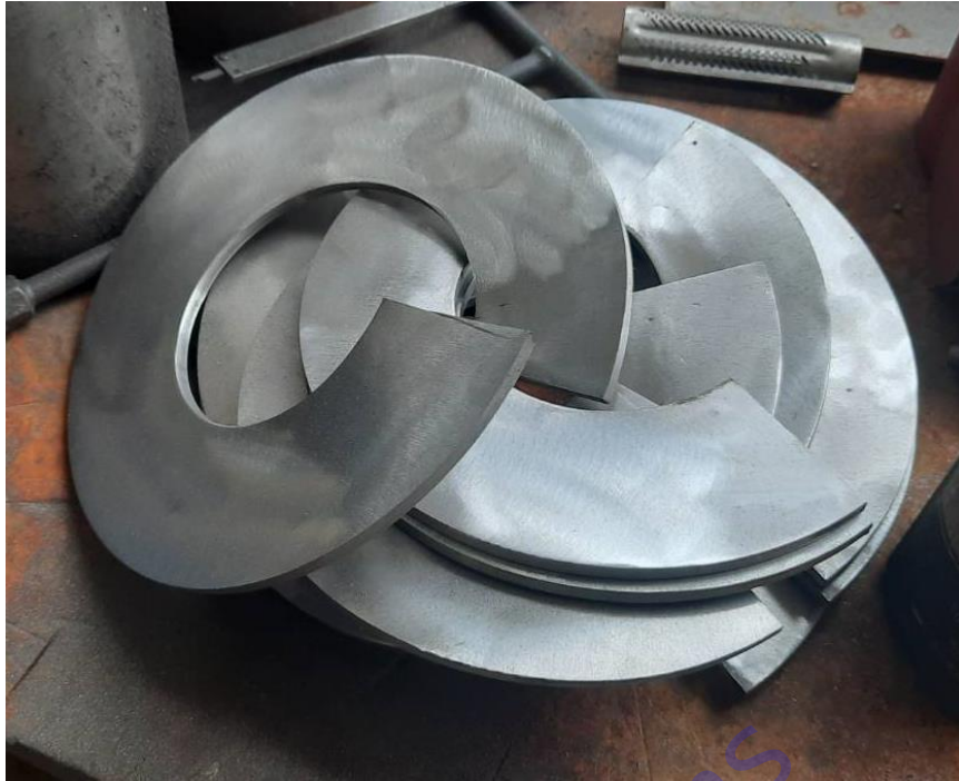
ภาพที่ 14 สร้างใบสกรูอัดแบบ Variable pitch screw
