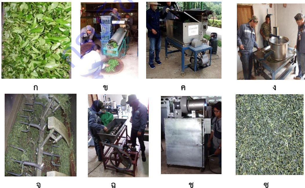
ภาพที่ 8 ก ยอดชาสด ข อบไอน้ำยอดชา ค นวดลดความชื้นครั้งที่ 1 ง นวดในเครื่องนวดทรงกระบอก จ นวดลดความชื้นครั้งที่ 2 ฉ รีดขึ้นรูป ช อบแห้ง ซ ชาเขียวหลังอบแห้ง
