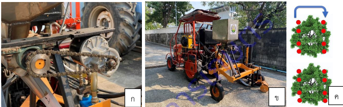
ภาพที่ 6-2.1 เฟืองขับลูกหยอด (ก) ต้นแบบเครื่องฝัງปุ๋ยแบบปรับอัตราหยอดอัตโนมัติ (ข) และ รูปแบบการเคลื่อนที่สำหรับการเจาะหลุมและการหยอดปุ๋ย 8 หลุมรอบต้น (ค)
