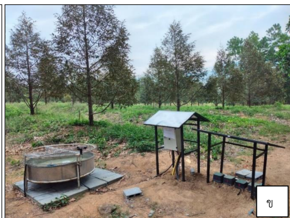
ภาพที่ 6-1.2 แผนผังวงจรระบบควบคุมอัตโนมัติการให้น้ำทุเรียนโดยใช้ค่าจากถาดวัดระเหย (Epan) ก) ระบบควบคุมอัตโนมัติการให้น้ำทุเรียนโดยใช้ค่าจากถาดวัดระเหย (Epan) ที่ติดตั้งในแปลงทดสอบ ข)
