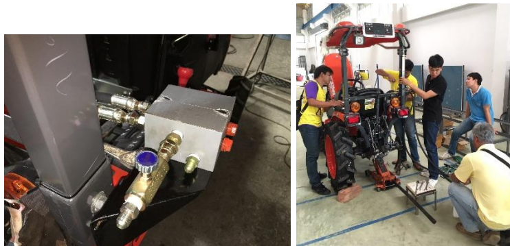
(2) ติดตั้งชุดควบคุมอัตราการไหลของน้ำมันไฮดรอลิค
