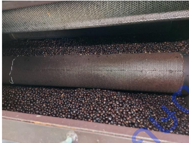
ภาพที่ 16 เมล็ดกาแฟยวบตัวลง จนระดับเมล็ดกาแฟต่ำกว่าท่อลมออก
