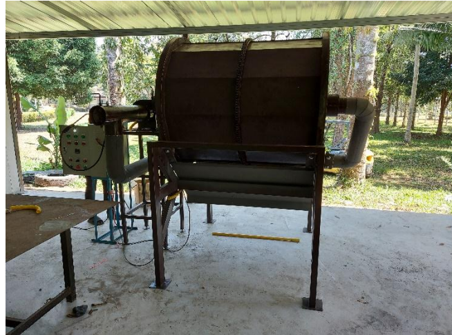
ภาพที่ 12 ตู้ควบคุมเครื่องอบและชุดเครื่องอบ
