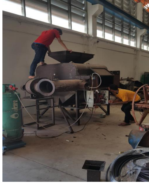
ภาพที่ 2 ทำการปรับปรุงเครื่องอบโรตารีเดิมเพื่อใช้ทดสอบอบกาแฟ
