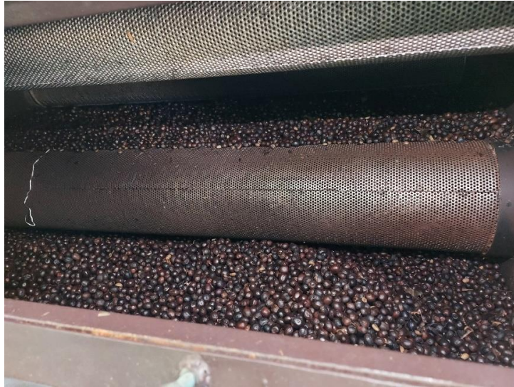
ภาพที่ 15 เมล็ดกาแฟบดตัวลง จนระดับเมล็ดกาแฟต่ำกว่าท่อลมออก
