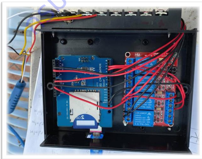
ภาพที่ 3 สมองกลฝังตัว ทำหน้าที่ควบคุมอุณหภูมิและความชื้นอัตโนมัติ
