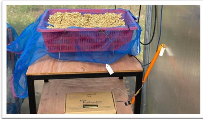
ภาพที่ 4 เครื่องชั่งแบบบันทึกน้ำหนักอัตโนมัติโดยใช้สมองกลฝังตัว การลดความชื้นด้วยโรงตากพลังงานแสงอาทิตย์ กะลาตากแห้ง มีความชื้นเริ่มต้นร้อยละ 55 มาตรฐานเปียก (wb) มีอุณหภูมิตลอดการทดลอง สูงสุด 39.4 องศาเซลเซียส ต่ำสุด 6.1 องศาเซลเซียส เฉลี่ย 18.73 องศาเซลเซียส ความชื้นสัมพัทธ์เฉลี่ย 57.27%
