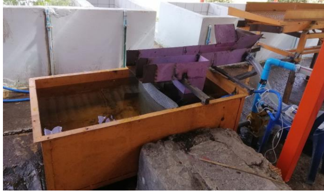
ภาพที่ 8 ต้นแบบเครื่องล้างผลกาแพที่ปรับปรุงใหม่
