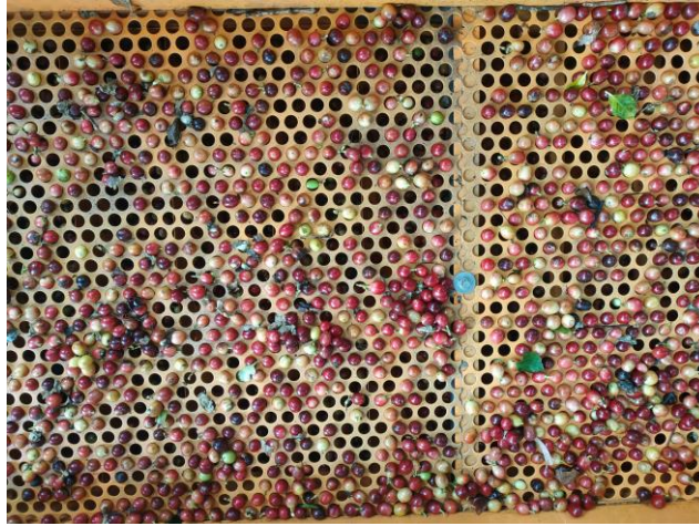
ภาพที่ 4 ผลการทดสอบตะแกรงรูกกลมขนาด 10 มิลลิเมตร
