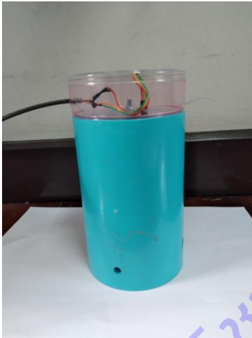
(ค) เซนเซอร์วัดระดับน้ำโดยใช้ pressure switch
