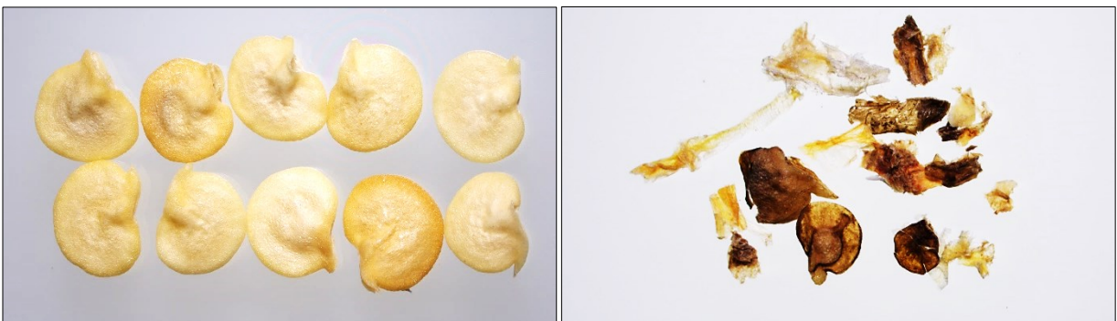
ภาพที่ 1 ลักษณะเมล็ดพันธุ์พริก และเศษชิ้นส่วนพืชที่ติดมากับเมล็ด ภายใต้กล้องสเตอริโอที่กำลังขยาย 10 เท่า
