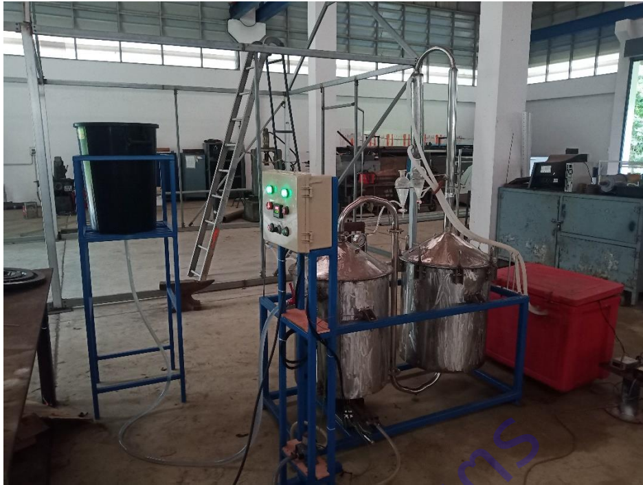
ภาพที่ 2.15 ชุดต้นแบบเครื่องสกัดน้ำมันหอมระเหยระดับเกษตรกรจากพืชกระวาน
