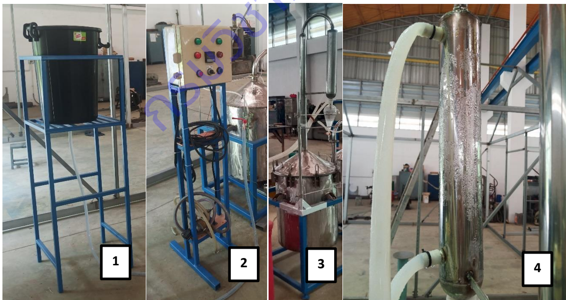
ภาพที่ 2.14 (1) ชุดโครงถังเก็บน้ำ (2) ชุดโครงตู้ควบคุมอุณหภูมิ (3) ชุดท่อสำหรับส่งผ่านไอน้ำร้อน ไอน้ำมันกระวาน (4) ชุดควบแน่นน้ำมันหอมระเหย
