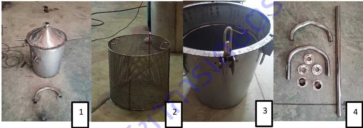
ภาพที่ 2.11 (1) ชุดถังผลิตไอน้ำร้อน (2) ถังตะแกรงใส่วัสดุทดสอบ (3) ชุดถังกลั่น (4) ชุดท่อส่งผ่านไอน้ำร้อน
