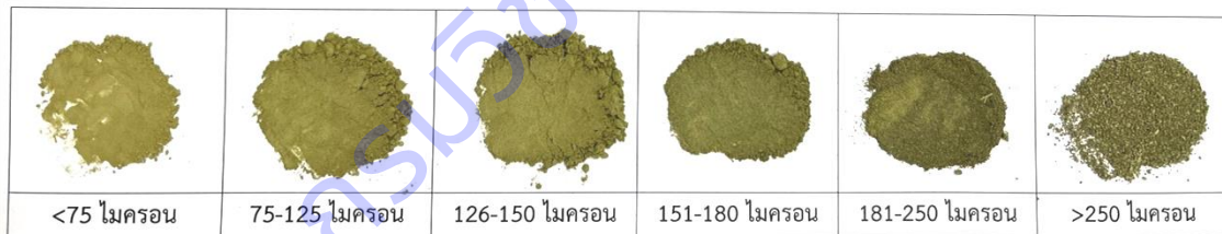
ภาพที่ 7 ขนาดของผงชามัทฉะหลังจากคัดแยกด้วยเครื่องเย่าตะแกรงร้อน
