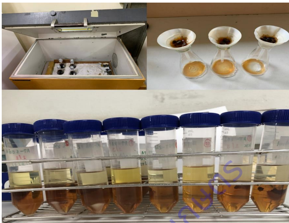
ภาพที่ 9 การเลี้ยงราดินในอาหารเหลวและการเก็บตัวอย่างอาหารเหลวเพื่อสกัดสาร atrazine
