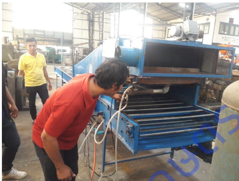
ภาพที่ 24 อุปกรณ์ให้ความร้อนแบบรังสีอินฟราเรดผ่านแหล่งความร้อนจากแก๊ส LPG
