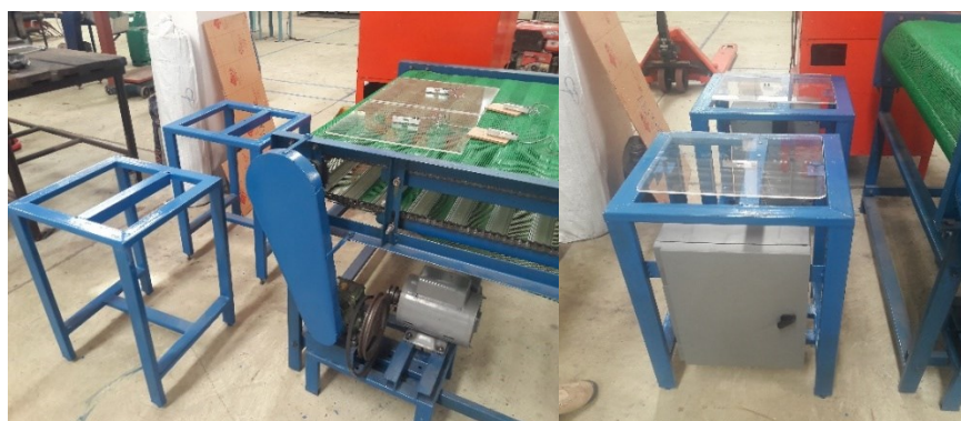
ภาพที่ 12 ชุดชั่งน้ำหนักกล้วยไม้หลังลดความชื้นด้วยเครื่องอุโมงค์ลม
