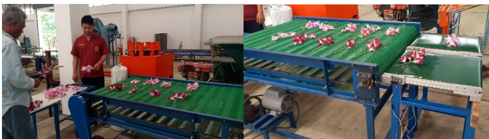
ภาพที่ 13 ทดสอบชุดลำเลียงกล้วยไม้ร่วมกับชุดชั่งน้ำหนักกล้วยไม้เริ่มต้น
