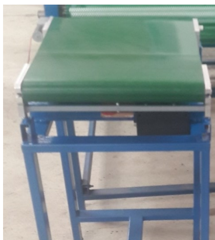
ภาพที่ 18 ติดตั้ง Loadcell ตัวที่หนึ่ง ในชุดชั่งน้ำหนักกล้วยไม้เริ่มต้น
