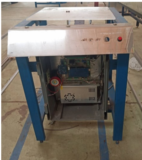
ภาพที่ 37 ชุดชั่งน้ำหนักก่อนลดความชื้นกล้วยไม้ด้วยเครื่องแบบอุโมงค์ลม
