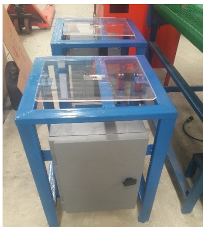
ภาพที่ 19 ติดตั้ง Loadcell ตัวที่สอง และตู้ควบคุม ในชุดชั่งน้ำหนักกล้วยไม้หลังลดความชื้นด้วยเครื่องอุโมงค์ลม
