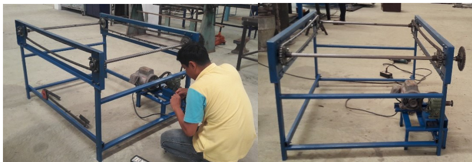
ภาพที่ 7 ติดตั้งชุดต้นกำลังมอเตอร์ไฟฟ้า เกียร์ทด และเฟืองโซ่ขับชุดลำเลียง
