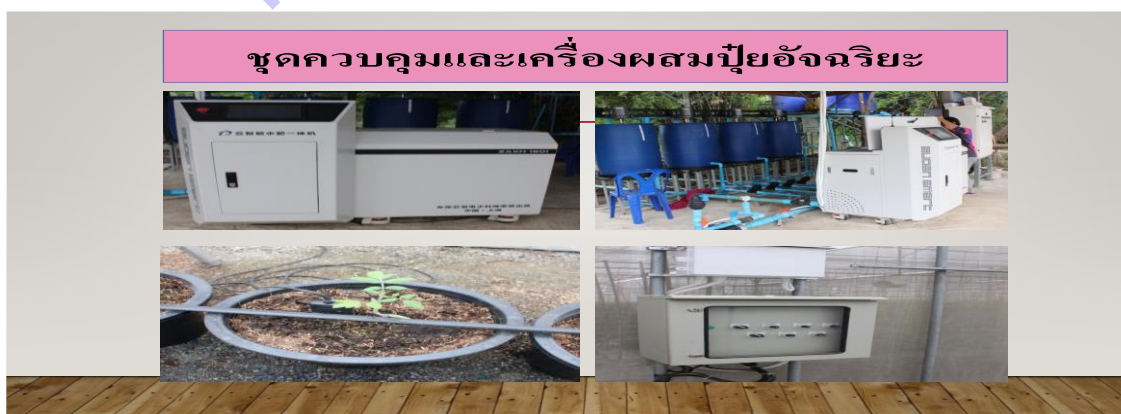
ภาพที่ 7 เทคโนโลยีการจัดการน้ำ ปุ๋ยและสภาพแวดล้อมผ่านระบบ IOT การผลิตมะเขือเทศในโรงเรือนอัจฉริยะ จังหวัดสุพรรณบุรี
