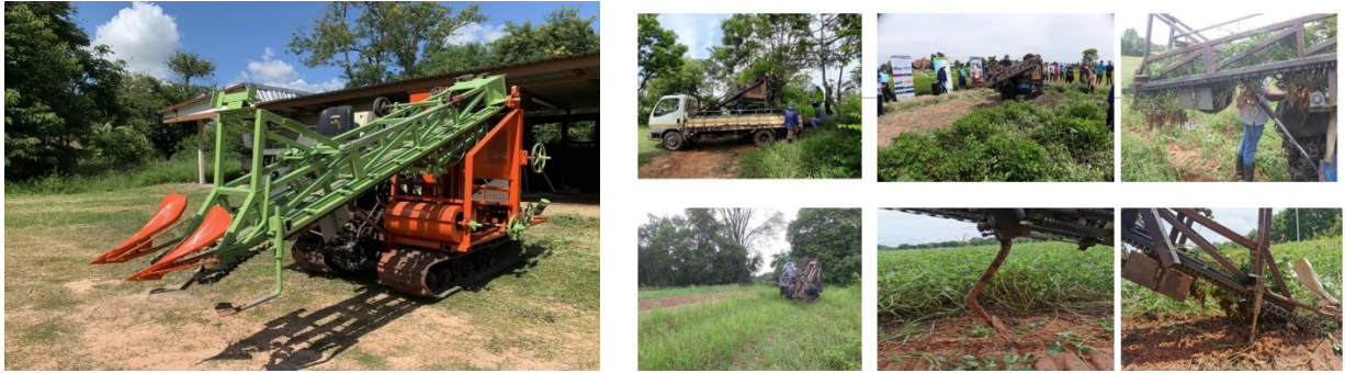
ภาพที่ 6 เครื่องต้นแบบชุดและปลิดถั่วลิสง และการทดสอบภาคสนาม
