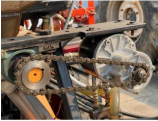
มอเตอร์กระแสตรง สำหรับควบคุมการจ่ายปุ๋ย
