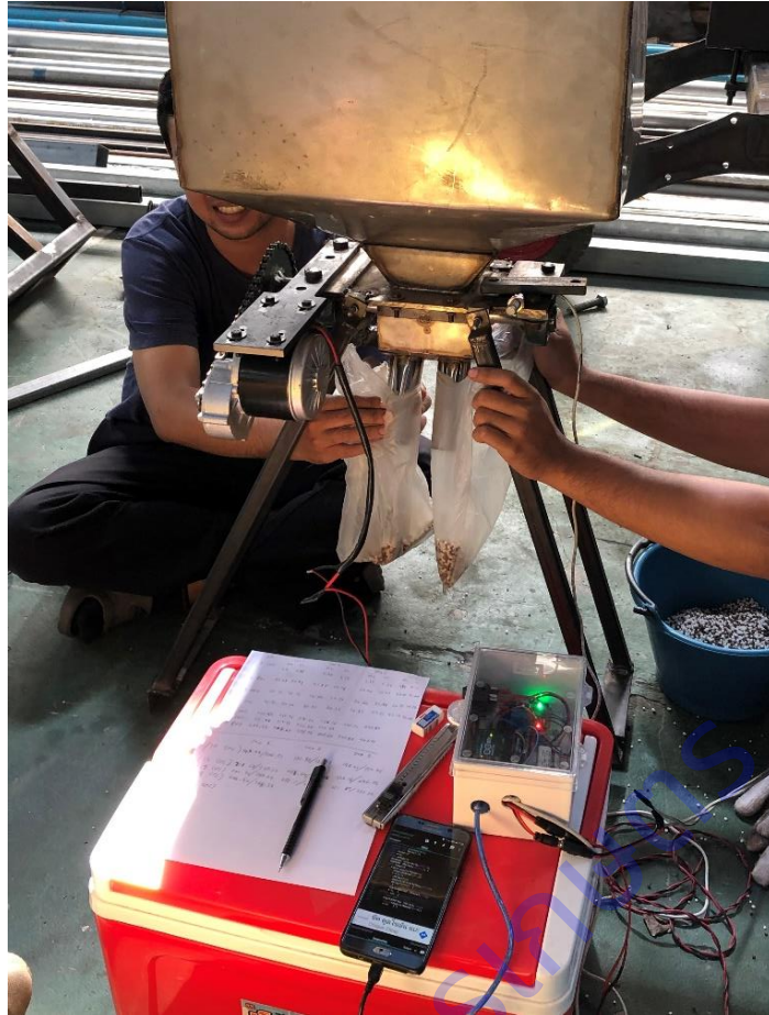
ภาพที่ 15 การทดสอบการสอบเทียบอัตราการหยดปุ๋ย
