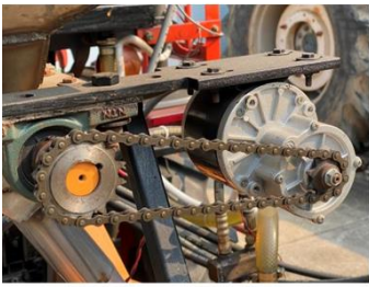
มอเตอร์กระแสดรง สำหรับควบคุมการจ่ายปุ๋ย
