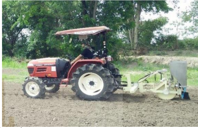
ภาพที่ 3 เครื่องไถปุ๋ยแบบเจาะหลุมอัตโนมัติสำหรับยางพารา (มงคล, 2560)
