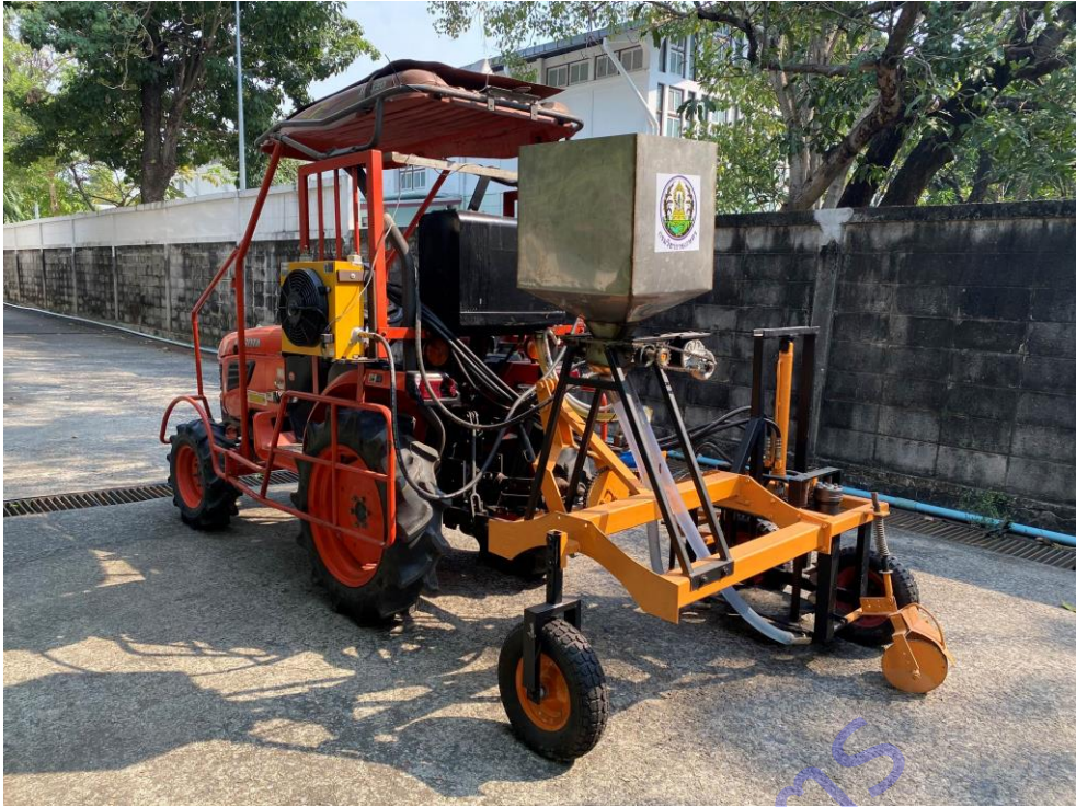
ภาพที่ 17 ต้นแบบเครื่องฝัງปุ๋ยแบบปรับอัตราหยอดอัตโนมัติ
