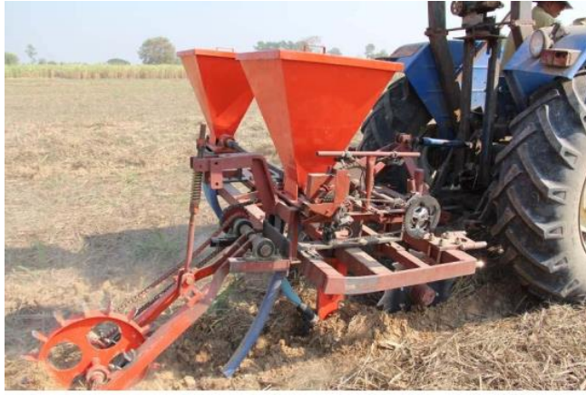
ภาพที่ 1 เครื่องหยอดปุ๋ยสำหรับปุ๋ยผสม (ขนิษฐ และคณะ, 2558)
