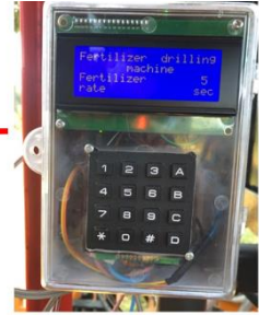
ระบบควบคุมและประมวลผล
