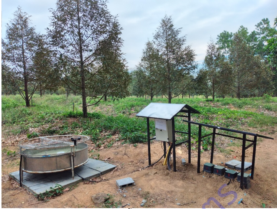
รูปที่ 9 ระบบควบคุมอัตโนมัติการให้น้ำทุเรียนโดยใช้ค่าจากถาดวัดระเหย (Epan)
