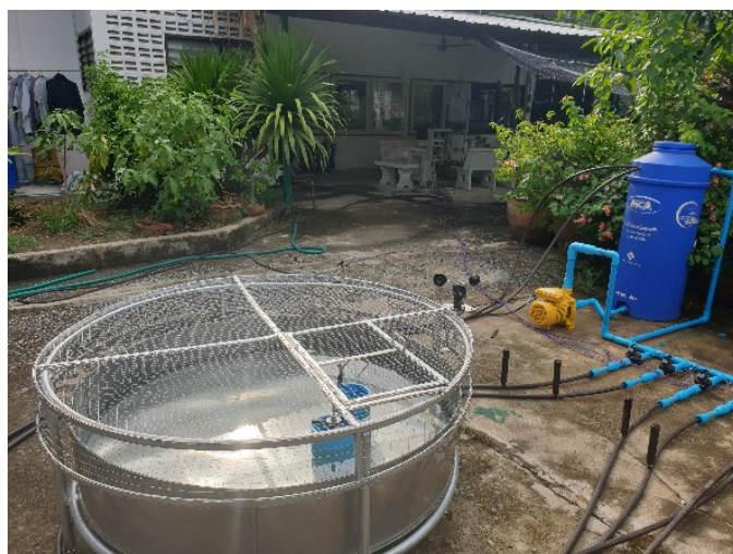
(ข) ชุดควบคุมอัตโนมัติการให้น้ำพืชและระบบให้น้ำ
