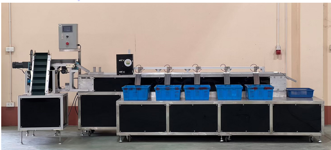
ภาพที่ 31 ต้นแบบเครื่องคัดคุณภาพผลสตรอเบอร์รี่โดยเทคนิคประมวลผลภาพ เบื้องต้น
