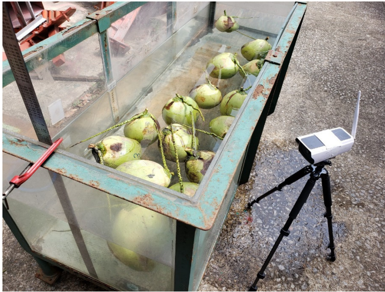
ภาพที่ 5 ต้นแบบเครื่องคัดแยกคุณภาพมะพร้าว น้ำหอมด้วยวิธีความถ่วงจำเพาะ
