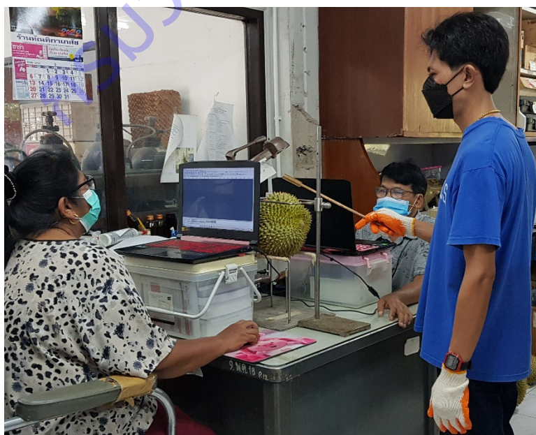
ภาพที่ 10 การเคาะทุเรียนเพื่อเก็บข้อมูลเสียงเคาะ
