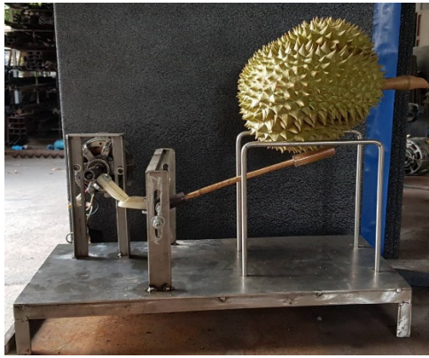
ภาพที่ 4 (ภาคผนวก) ต้นแบบอุปกรณ์ตรวจวัดความสุกแก่ของทุเรียนด้วยคลื่นเสียงเบื้องต้น
