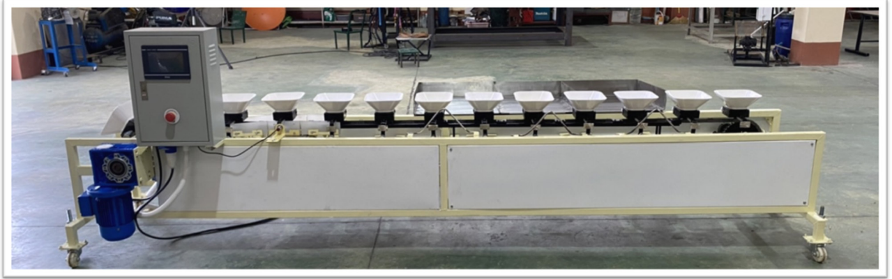
ภาพที่ 7 (ภาคผนวก) ต้นแบบเครื่องคัดแยกเมล็ด่อนโดยน้ำหนักรัดอัตโนมัติ เบื้องต้น
