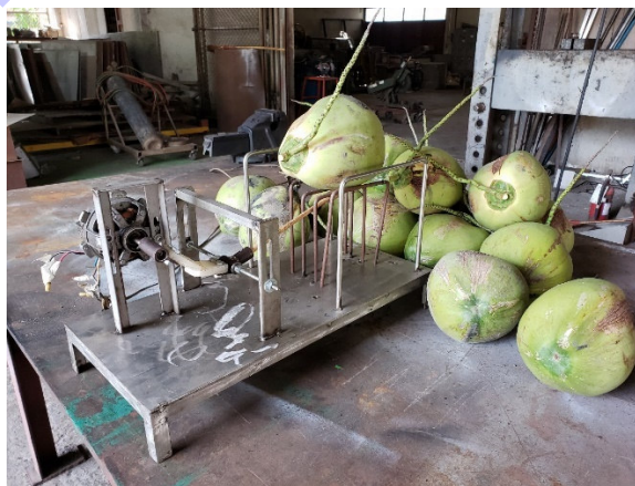
ภาพที่ 3 (ภาคผนวก) ต้นแบบเครื่องวัดคุณภาพมะพร้าวด้วยคลื่นเสียง เบื้องต้น
