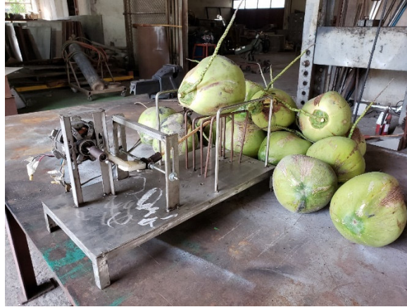
ภาพที่ 7 ต้นแบบเครื่องวัดคุณภาพมะพร้าวด้วยคลื่นเสียงเบื้องต้น
