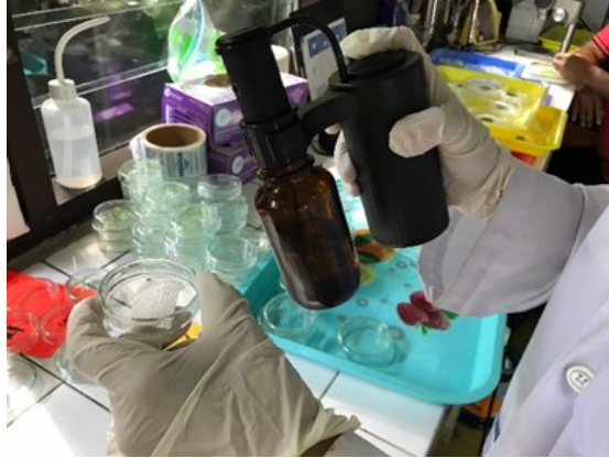
ภาพที่ 47 ฉีดพ่นสารสกัดจากพืชด้วยเครื่อง TLC sprayer
