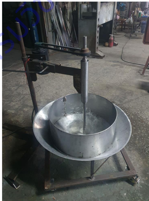
ภาพที่ 47 ต้นแบบชุดทดสอบระดับปัจจัยสำหรับกระบวนการกวนน้ำตาลมะพร้าว
