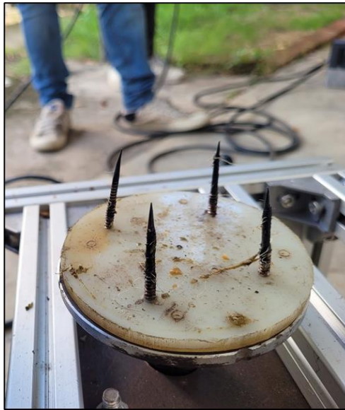
ภาพที่ 37 หัวจับยึดผลมะพร้าวที่เกิดการบิดงอจากการติดขัดขณะปอกมะพร้าว
