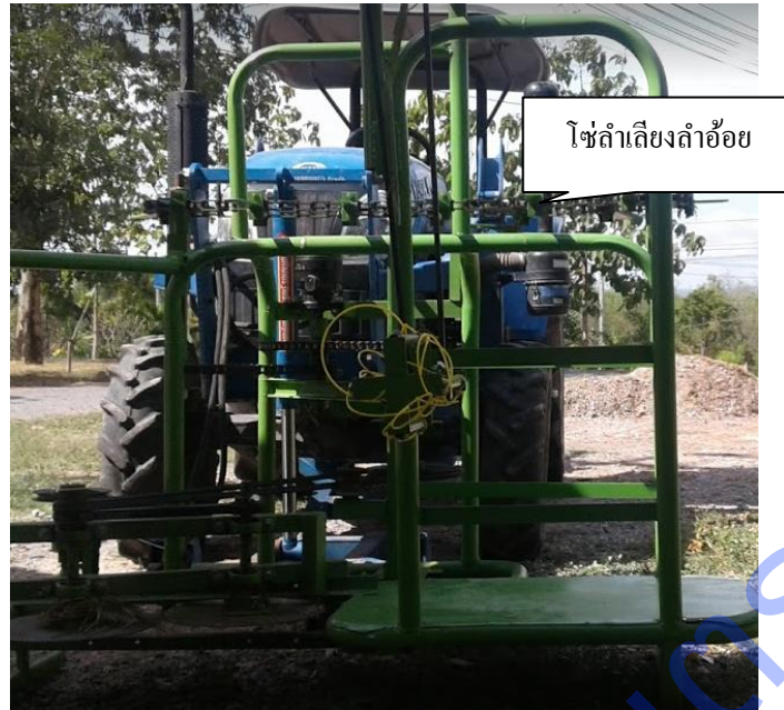
ภาพที่ 16 ตำแหน่งของโซ่ลำเลียงลำอ้อย
