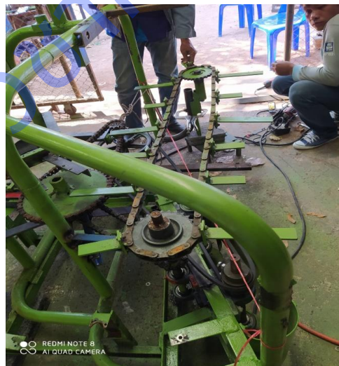
ภาพที่ 19 ปรับตำแหน่งโซ่และใบตัด
