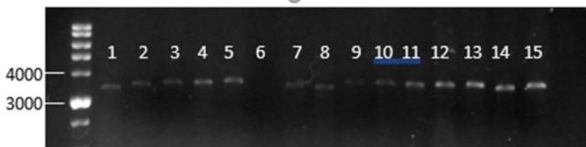
ภาพที่ 6 แลบดีเอ็นเอที่ได้จากการทำพีซีอาร์ด้วยไพรเมอร์ F2 5'-GCGTACGTGGAACCACAA-3' และ R2 5'-CTCCATTCTGGTGAGAAAGCGT-3' โดยใช้อุณหภูมิขั้นตอนในการจับคู่ระหว่างไพรเมอร์กับดีเอ็นเอเป้าหมายเท่ากับ 62 องศาเซลเซียส เป็นเวลา 30 วินาที (lane 1-15)
