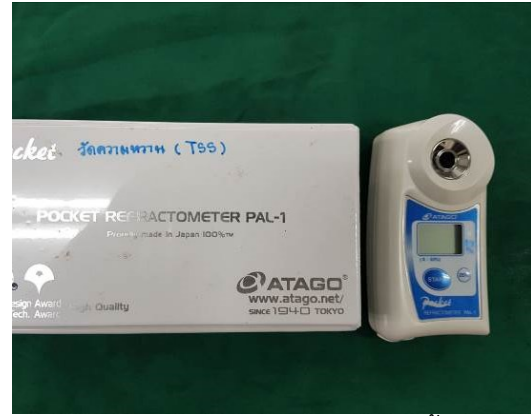
(ง) เครื่องวัดปริมาณของแข็งที่ละลายน้ำได้ (TSS)
