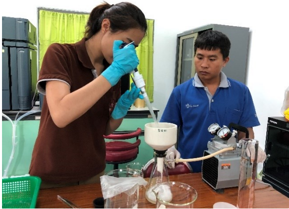
(ค) ตกตะกอน glycoalkaloids ด้วย \text{NH}_4\text{OH}
