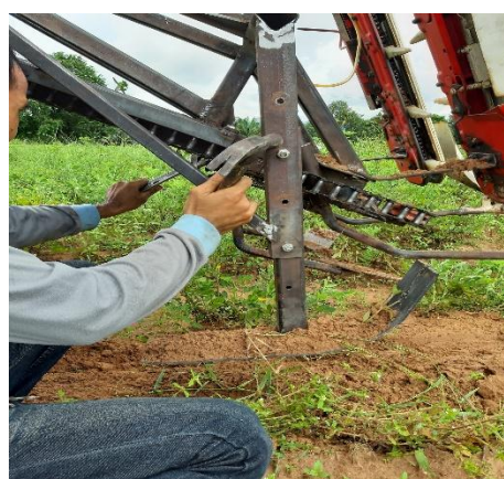
รูปที่ 45 สภาพแปลงที่มีฝนตกและชุดผลที่คายดินยากทำให้รถขุดติดขัด
