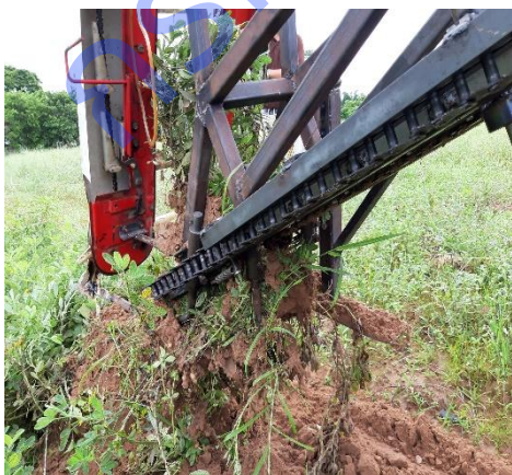
รูปที่ 45 สภาพแปลงที่มีฝนตกและชุดผลที่คายดินยากทำให้รถขุดติดขัด
