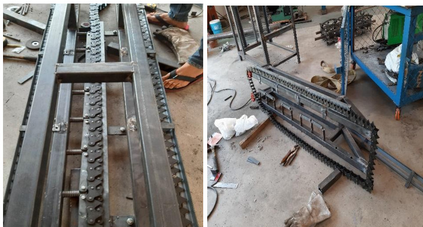
รูปที่ 18 ชุดโซ่หนีบประกอบโครงที่สร้างขึ้นมาเพื่อใช้ในการหนีบต้นถั่วและลำเลียงไปสู่การปลิด
