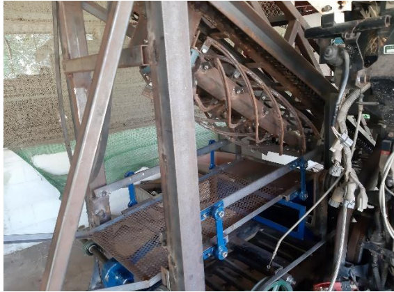
รูปที่ 39 แสดงชุดตะแกรงทำความสะอาดที่จะรองรับฝักถั่วที่ถูกปลิดลงมาจากชุดปลิด
