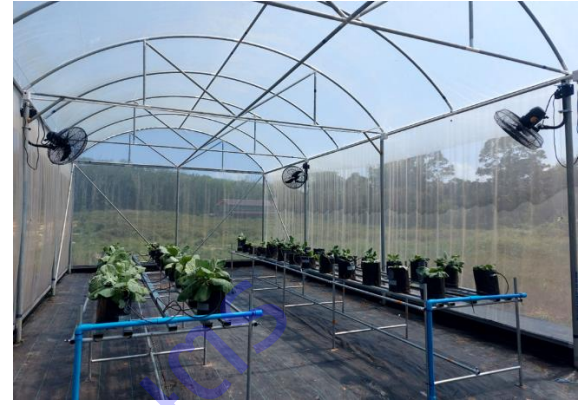
ภาพที่ 4.5 ต้นแบบโรงเรือนสำหรับทดสอบระบบการควบคุมสภาพอากาศและความชื้นสัมพัทธ์เบื้องต้น
