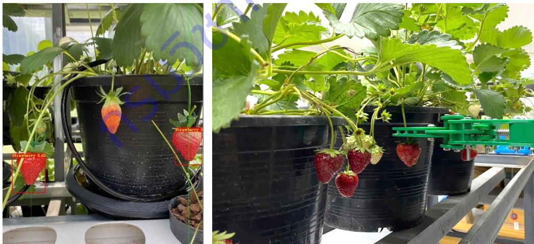
ภาพที่ 6.2 ระบบการตรวจจับผลสตรอเบอร์รี่โดยใช้เทคโนโลยีการประมวลผลภาพ (Image Processing)
