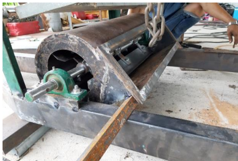
รูปที่ 38 ติดตั้งพัฒมทำความสะอาด
