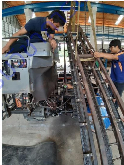
รูปที่ 30 วัดความเร็วรอบต้นกำลัง
