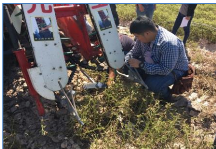
รูปที่ 3 และ 4 แสดงชุดใบมีดชุดถั่วลิสงของเครื่องเกี่ยวขนาดถั่วลิสงที่นำเข้าจากต่างประเทศ
