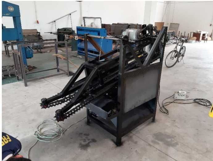
รูปที่ 23 ประกอบชุดโซ่หนึบต้นถั่วกับชุดปลิดฝักถั่วพร้อมทดสอบในห้องปฏิบัติการ
