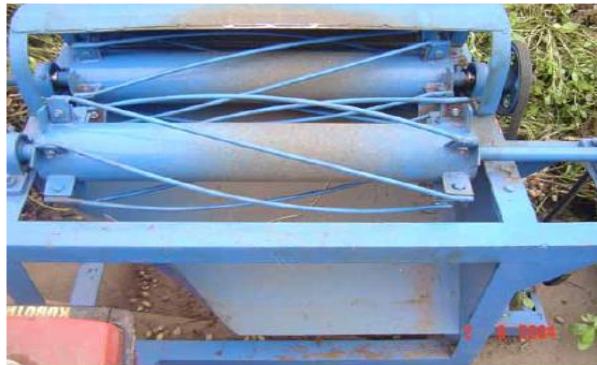
รูปที่ 10 แสดงลักษณะการทำงานของเครื่อง Groundnut picker BL-2T
