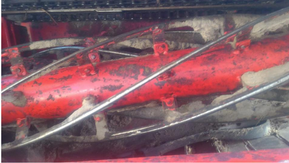
รูปที่ 18 ชุดปลิดฝักถั่วลิสงในเครื่องชุดจากไต้หวัน
