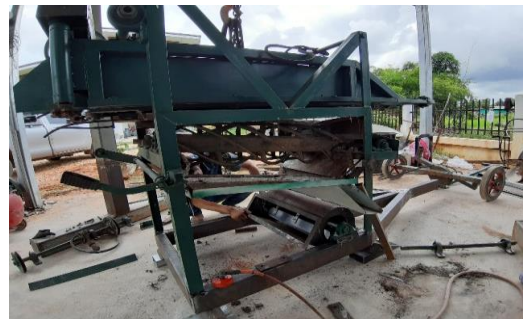
รูปที่ 38 ติดตั้งพัฒมทำความสะอาด
