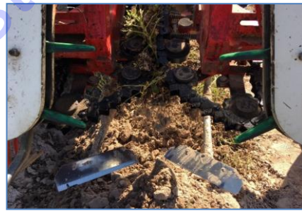
รูปที่ 3 และ 4 แสดงชุดใบมีดขุดถั่วลิสงของเครื่องเกี่ยวถั่วลิสงที่นำเข้าจากต่างประเทศ
