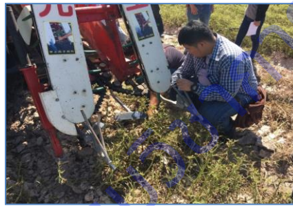
รูปที่ 3 และ 4 แสดงชุดใบมีดขุดถั่วลิสงของเครื่องเกี่ยวถั่วลิสงที่นำเข้าจากต่างประเทศ
