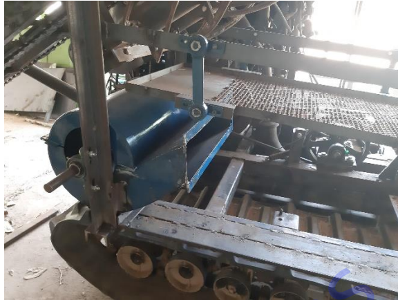
รูปที่ 39 ประกอบชุดตะแกรงทำความสะอาดและพัลลมเป่าสิ่งเจือปนบนรถ
