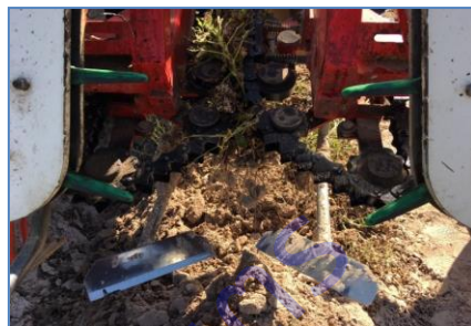
รูปที่ 3 และ 4 แสดงชุดใบมีดชุดถั่วลิสงของเครื่องเกี่ยวขนาดถั่วลิสงที่นำเข้าจากต่างประเทศ
