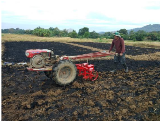
ภาพที่ 3 สาธิตและปรับใช้เครื่องปลูกถั่วเหลือง
