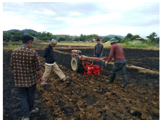
ภาพที่ 3 สาธิตและปรับใช้เครื่องปลูกถั่วเหลือง
