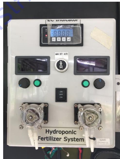
ภาพที่ 6 การทดสอบระบบผสมและระบบจ่ายปุ๋ยสารละลาย A B
