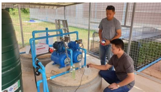
ภาพที่ 4 ทดสอบการวัดค่าการนำไฟฟ้า
