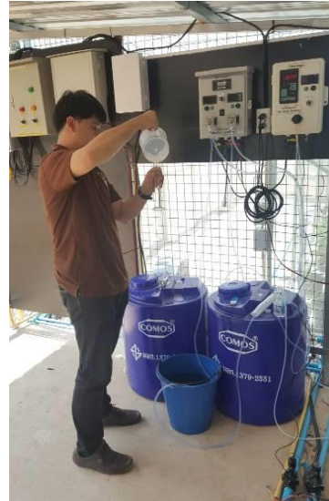
ภาพที่ 5 ทดสอบการวัดค่าการนำไฟฟ้า
