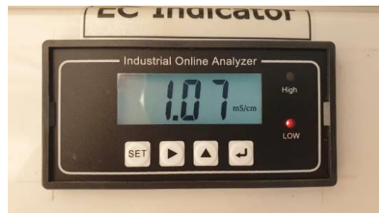
ภาพที่ 4 ทดสอบการวัดค่าการนำไฟฟ้า
