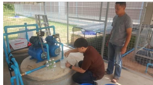
ภาพที่ 3 เตรียมสารละลายสำหรับการทดสอบวัดค่าการนำไฟฟ้า
