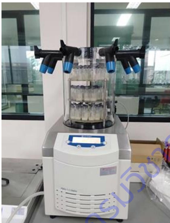
ภาพที่ 2 การทำไคตินเนสที่ผลิตจากกรรมวิธีต่างๆ ให้แห้งโดยนำเข้าสู่เครื่อง freeze dry
