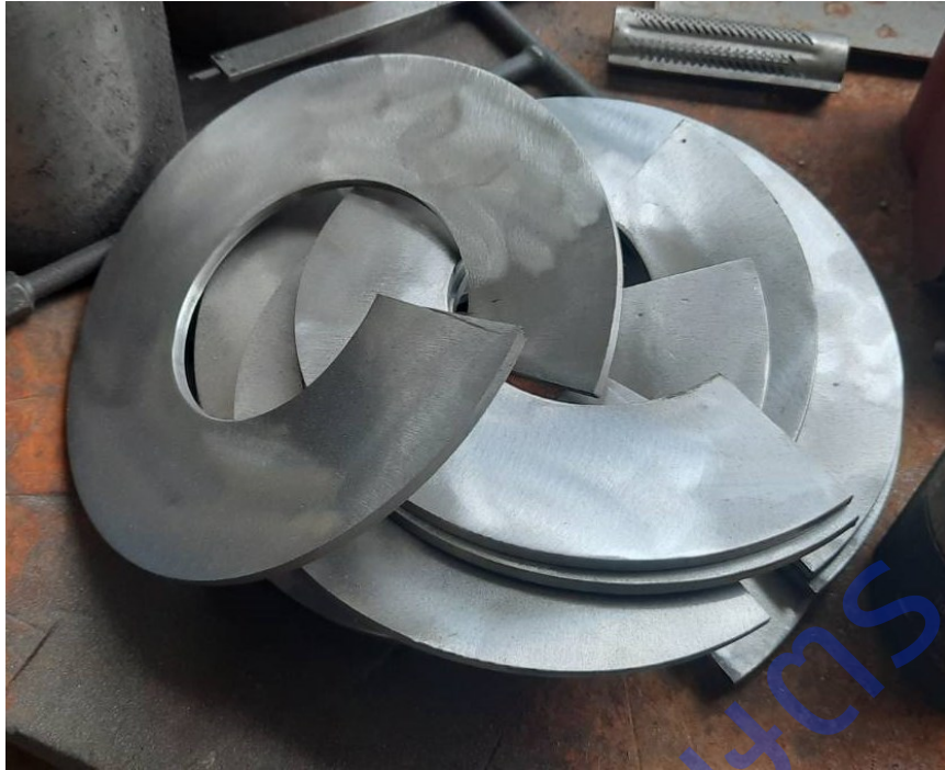
ภาพที่ 36 สร้างใบสกรูอัดแบบ Variable pitch screw
