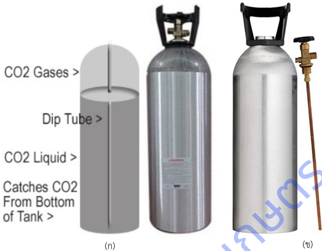
ภาพที่ 23 ลักษณะของ Dip tube สำหรับถังแก๊สคาร์บอนไดออกไซด์
