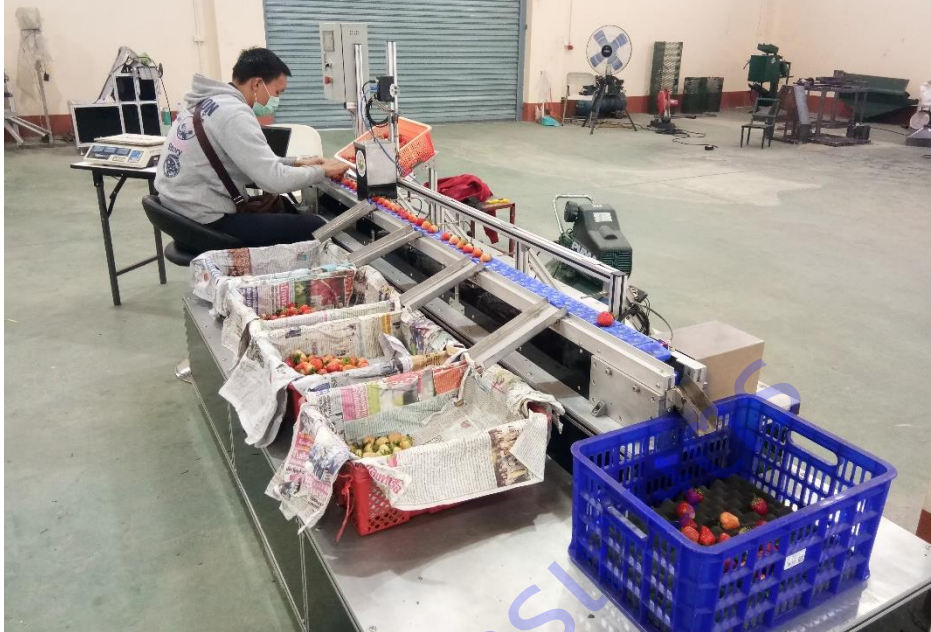
รูปที่ 23 ทดสอบเครื่องคัดแยกสีผลสตรอเบอร์รี่ด้วยเครื่องต้นแบบที่ปรับปรุงแก้ไขแล้ว
