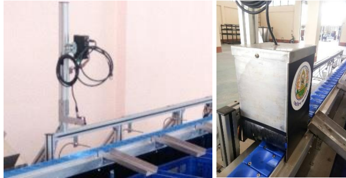
รูปที่ 20 ติดตั้งห้องครอบตัวกล้องบนสายพานคัตแยก ก่อนปรับปรุง (ซ้าย) หลังปรับปรุง (ขวา)
