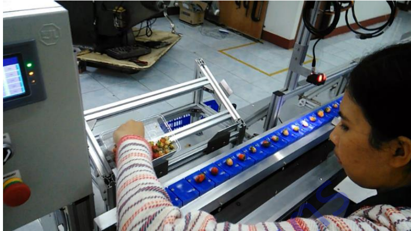
รูปที่ 14 ทดสอบการทำงานของโปรแกรมคัดแยกสีผลสตรอเบอร์รี่
