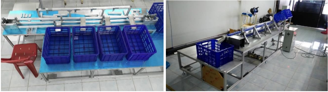
รูปที่ 16 สร้างต้นแบบเครื่องคัดแยกสีผลสตรอเบอร์รี่โดยใช้เทคนิค Image Processing
