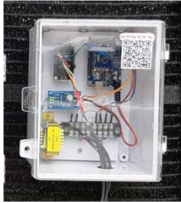
ภาพที่ 8 WiFi IoT สำหรับรายงานค่าอุณหภูมิและความชื้นสัมพัทธ์ในอากาศ
