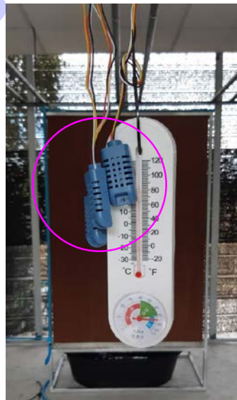
ภาพที่ 2 เซนเซอร์วัดอุณหภูมิและความชื้น
