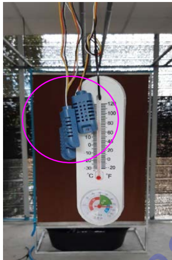
ภาพที่ 4 เซนเซอร์วัดอุณหภูมิและความชื้น
