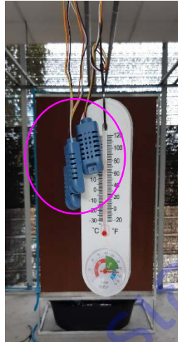
ภาพที่ 4 เซนเซอร์วัดอุณหภูมิและความชื้น
