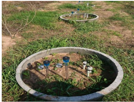
ภาพที่ 1 ติดตั้งอุปกรณ์สำหรับวัดความชื้นดิน PR2 และ Tensiometer
