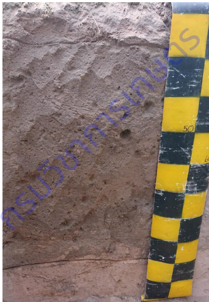
ภาพ 5 แสดงหน้าตัดชุดดินน้ำพองที่แปลงทดลองศูนย์วิจัยและพัฒนาปัจจัยการผลิตทางการขอนแก่น อำเภอเขาสวนกวาง จังหวัดขอนแก่น
