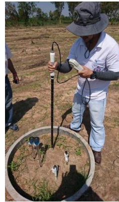
ภาพที่ 1 ติดตั้งอุปกรณ์สำหรับวัดความชื้นดิน PR2 และ Tensiometer
