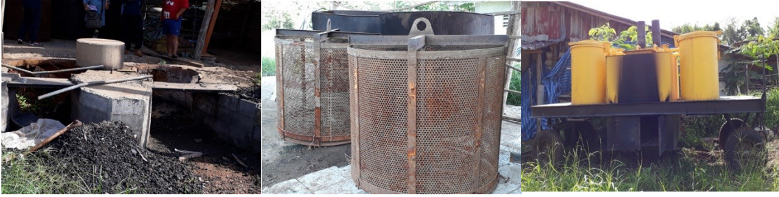
ภาพที่ 9 การทำวัตถุดิบแห้งขมิ้นชัน โดยใช้อุปกรณ์สำหรับทำขมิ้นต้ม เตาดต้ม หม้อต้มมีตะแกรง หม้อต้มไอน้ำเคลื่อนที่
