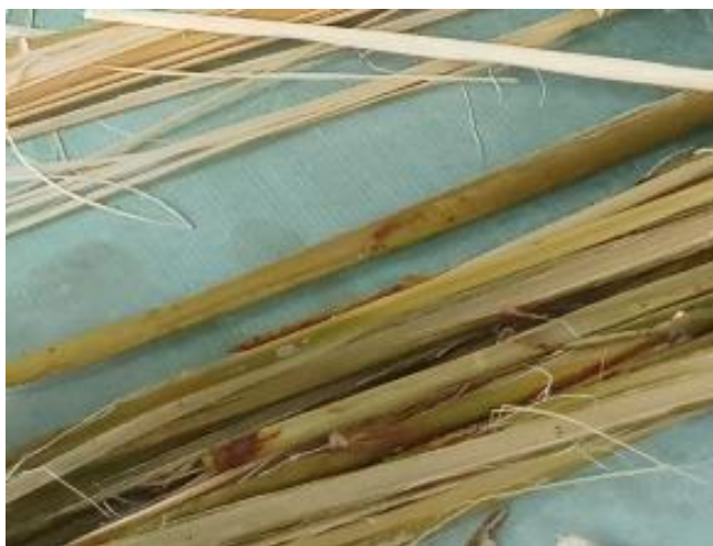
รูปที่ 5 ลักษณะเส้นใยที่ลอกได้และการเตรียมต้นกล้าจากการทดสอบครั้งที่ 3
