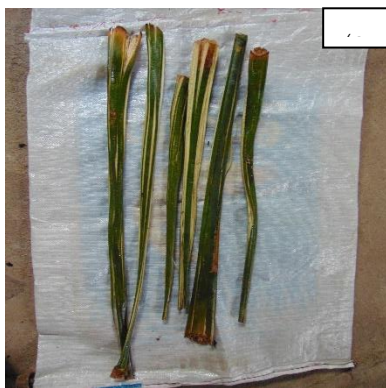
รูปที่ 1 ลักษณะต้นคล้าที่ได้จากการนำไปเข้าเครื่องรีด (ก) ลำต้นด้านนอกของต้นคล้าที่แยกลำต้นส่วนด้านในออก (ข)
