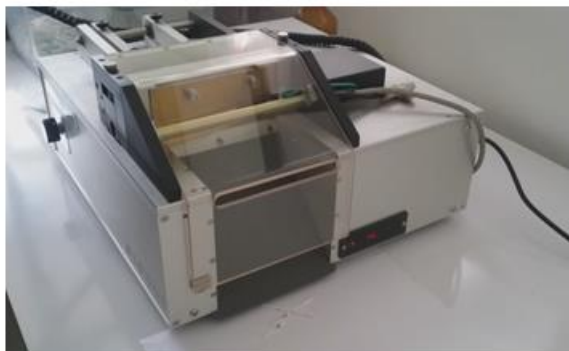
ภาพที่ 5 เครื่องตัดแบบอัตโนมัติ Bio dot ตัดให้มี strip มีความกว้าง 0.4 เซนติเมตร
