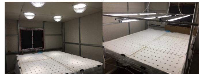
ท่ออลูมิเนียมนำแสงธรรมชาติ 4 ชุด เปรียบกับการใช้หลอดไฟ LED
