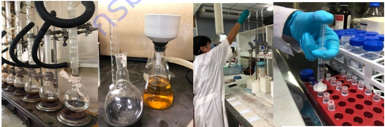
ภาพที่ 2 การสกัดสารกำจัดวัชพืชชนิดพาราควอตในดิน
