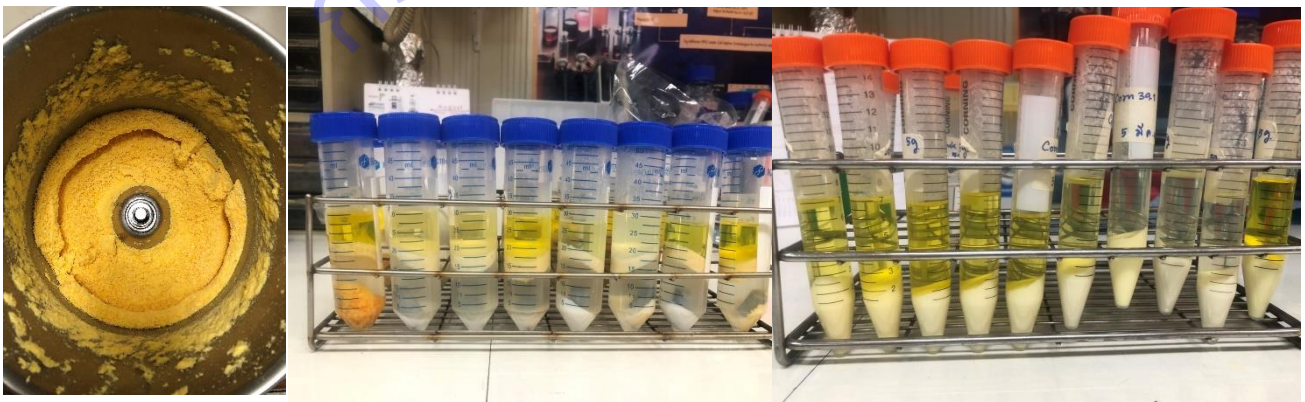
ภาพที่ 3 การสกัดสารพิษตกค้างในตัวอย่างข้าวโพด
