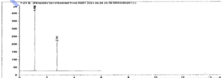
ภาพผนวกที่ ก4 แสดงโครมาโตแกรมของสารละลายมาตรฐาน pendimethalin
