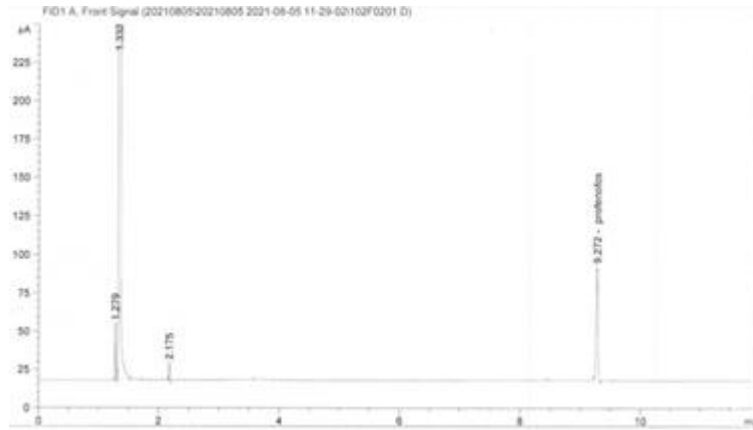
ภาพที่ 15 แสดงโครมาโตแกรมของสารละลายมาตรฐาน profenofos
