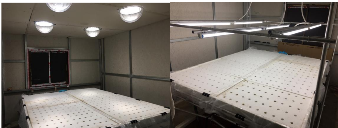
ภาพที่ 2.6 ท่ออลูมิเนียมนำแสงธรรมชาติ 4 ชุด เปรียบกับการใช้หลอดไฟ LED ในการทดลองปลูกผักสลัด
