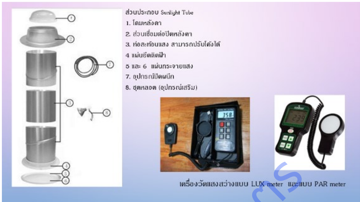
ภาพที่ 2.2 ส่วนประกอบระบบท่อนำแสงและเครื่องมือวัดความเข้มแสง
