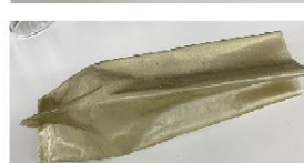
ภาพที่ 47 แผ่นฟิล์มผสม (สาหร่าย:PVA:แป้งสตาร์ช) และการซีลขึ้นรูปถุงเพาะชำ
