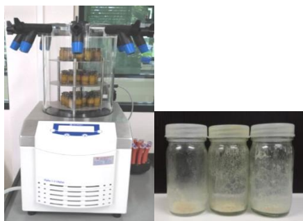
ภาพที่ 1-11 ผลิตภัณฑ์กรดอะมิโนลิวซีน (ALA) ที่ผ่านการทำให้อยู่ในสภาพผงแห้ง โดยใช้เทคนิคการทำแห้งแบบเยือกแข็ง (Freeze drying)
