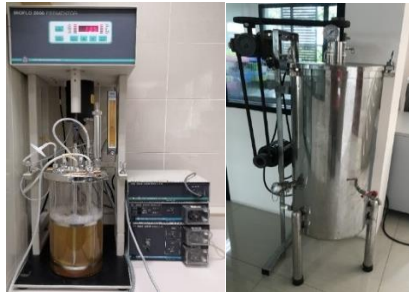
ภาพที่ 1-5 ก. การผลิตกรดอะมิโนลิวูลินิก (ALA) ในระบบถังหมักขนาดเล็ก (BIOFLO 2000 Fermenter) ข. การผลิตกรดอะมิโนลิวูลินิก (ALA) ในระบบถังหมักขนาด 50 ลิตร
