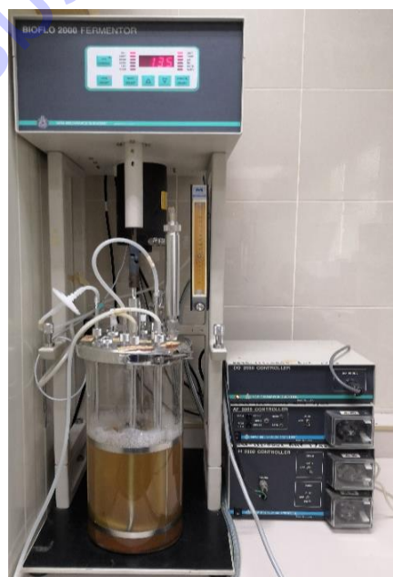
ภาพที่ 1.1-9 การผลิตกรดอะมิโนลิวลินิก (ALA) ในระบบถังหมักขนาดเล็ก (BIOFLO 2000 Fermenter)
