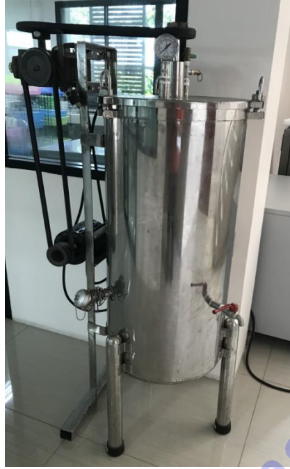
ภาพที่ 1.1-11 การผลิตกรดอะมิโนลิวซีน (ALA) ในระบบถังหมักขนาด 50 ลิตร
