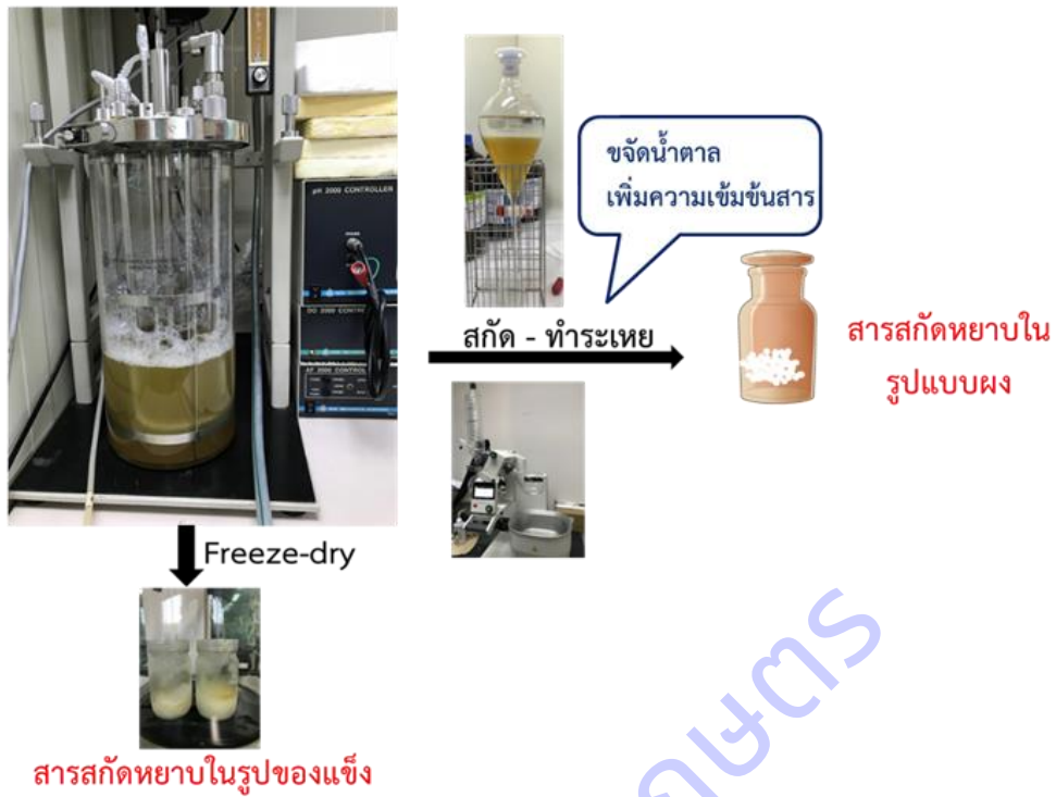
ภาพที่ 2.1-13 การขยายปริมาณการเลี้ยง E. coli เพื่อการผลิตเมลาโทนินในระดับถังหมักขนาดเล็ก
