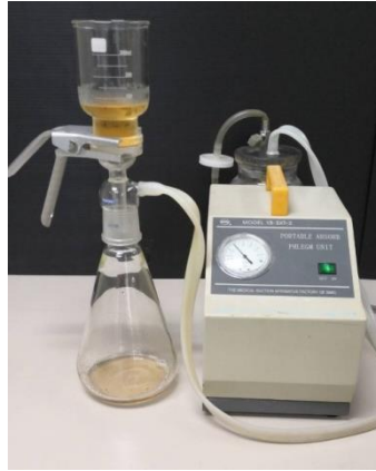
ภาพที่ 1.1-10 การแยกตะกอนเซลล์และโปรตีนของเซลล์แบคทีเรียออกโดยวิธีการกรองด้วยระบบสุญญากาศผ่าน filter membrane ขนาด 0.2 ไมโครเมตร
