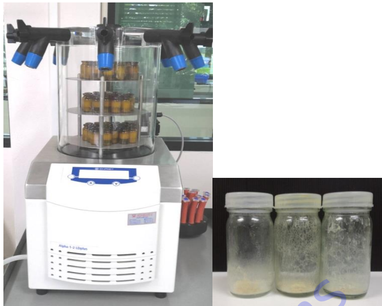
ภาพที่ 1.2-9 ผลิตภัณฑ์กรดอะมิโนลิวูลินิก (ALA) ที่ผ่านการทำให้อยู่ในสภาพผงแห้ง โดยใช้เทคนิคการทำแห้งแบบเยือกแข็ง (Freeze drying)
