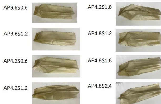
ภาพที่ 4 แผ่นฟิล์มผสม (สาหร่าย:PVA:แป้งสตาร์ช) จากกรรมวิธีที่ 5-8 และผลการซีลขึ้นรูปถุงเพาะชำ
